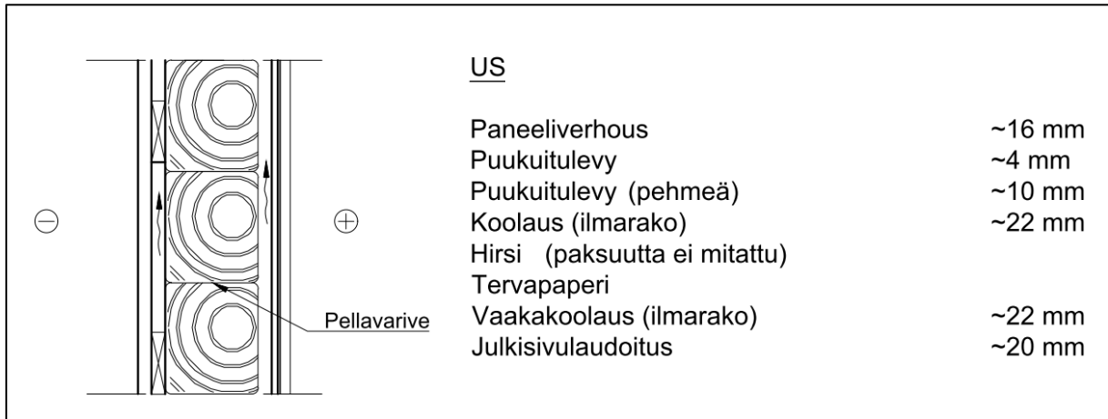
Kuva 23. Ulkoseinän periaateleikkaus liikuntasalin kohdalta, RA4.
